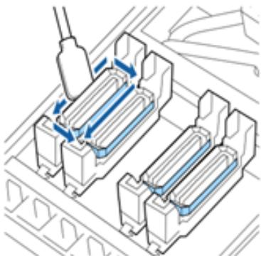
Vérifiez si de l'encre est collée sur la section de guide à l'avant et à l'arrière des capuchons ou si des fibres sont présentes à l'intérieur des capuchons ou du tampon de rinçage.
