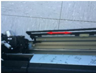
Ensuite on peut procéder au nettoyage de la réglette sur toute sa longueur à l'aide d'un chiffon. Une fois le nettoyage effectué, remettre la réglette en position de départ.
