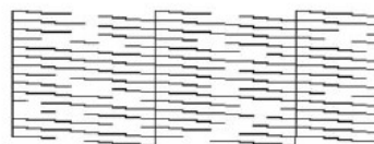
Exemple de buses obstruées
