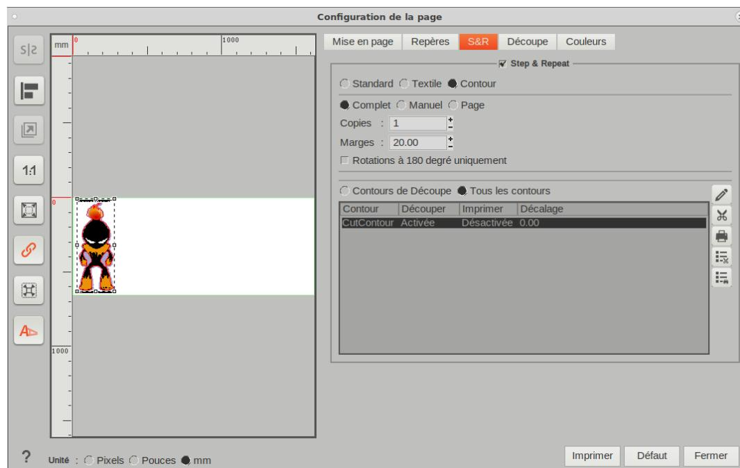
Aller dans l'onglet **Découpe**, choisir votre machine de découpe et ajuster si besoin les paramètres.
