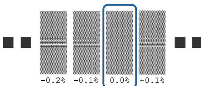
**Motif d'alignement de tête** : le 2ème motif imprimé permet d'effectuer un alignement des têtes d'impression. Sélectionner le motif où la ligne est la plus fine (les 2 lignes se chevauchent parfaitement) et saisir la valeur sur le panel de la machine à l'aide des flèches.
