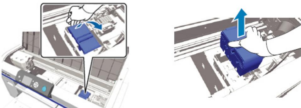
Procédez au retrait du capuchon anti-séchage en appuyant sur le levier puis en le soulevant. Retirez le couvercle du nouveau capuchon, puis placez le de la façon suivante
