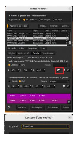
Une fois la mesure faite les valeur Lab s'appliquent automatiquement dans la partie supérieure et caldera calcule la conversion de cette couleur dans le gamut de l'imprimante
