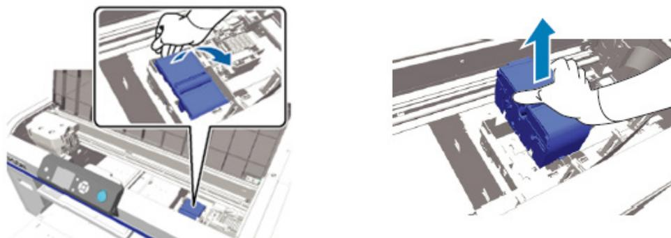
Procédez au retrait du capuchon anti-séchage en appuyant sur le levier puis en le soulevant. Retirez le couvercle du nouveau capuchon, puis placez le de la façon suivante
