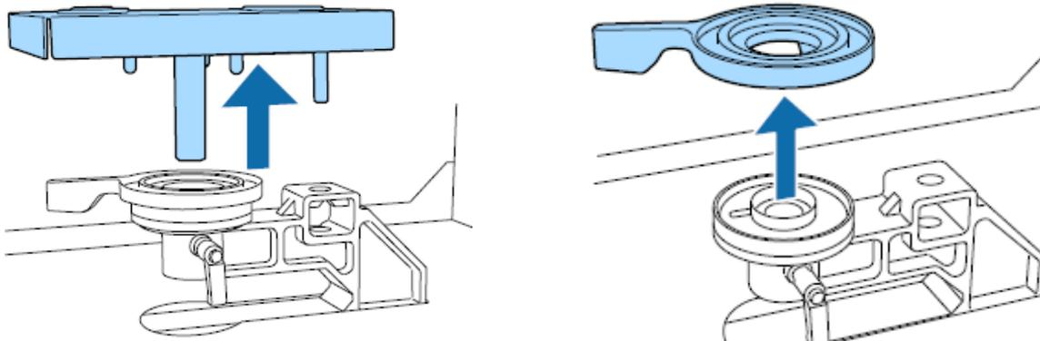
Il n'y a pas d'ordre d'empilement particulier lors de l'installation des deux dispositifs d'écartement. Par contre, il faut veiller à ce que le pion du dispositif soit correctement aligné avec le trou comme illustré ci-contre.
