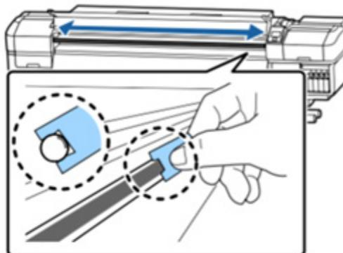
Fermez ensuite le capot et appuyez sur la touche OK. Le chariot se déplace d'arrière en avant. Les tampons enduits de graisse doivent être mis au rebut comme les cartouches d'encre.
