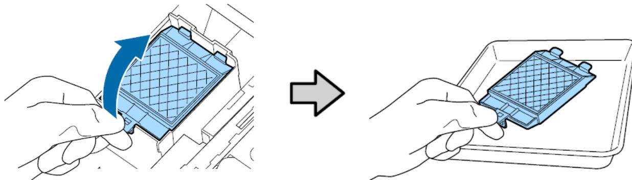
Positionnez le nouveau tampon de rinçage en insérant les 2 crochets dans les fentes comme indiqué ci dessous, et appuyez sur la languette jusqu'à ce qu'un déclic confirme la bonne mise en place.
