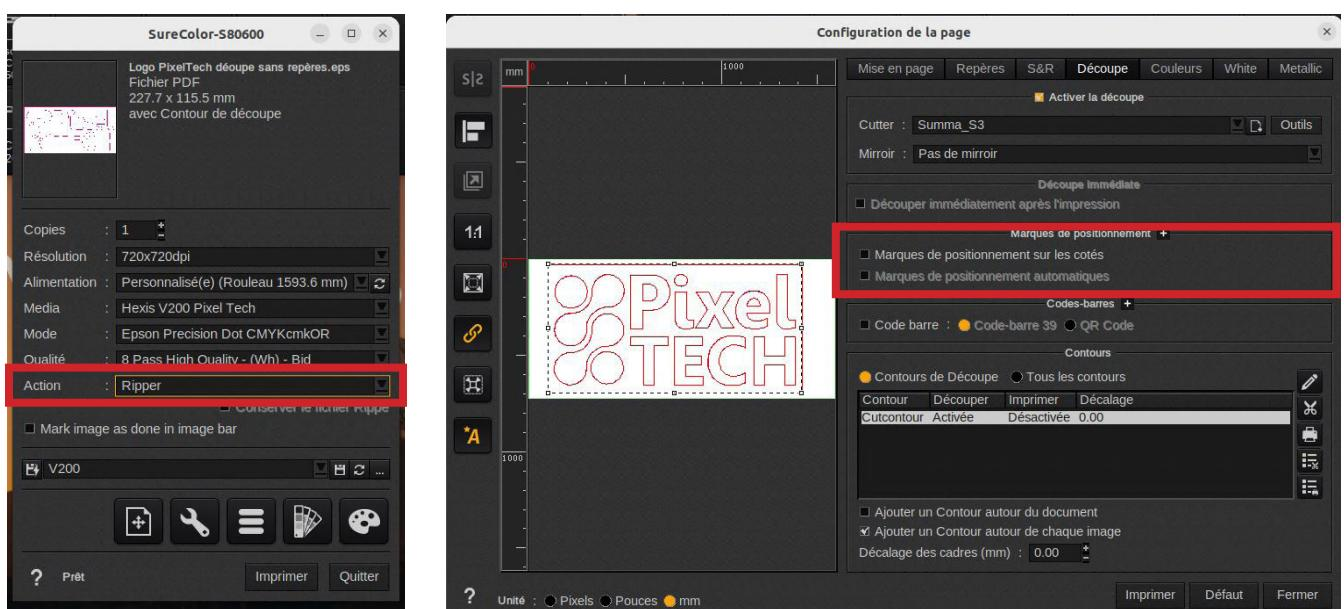
Maintenant, ouvrir le driver de la machine de découpe (**Visual Cut**) et dans la fenêtre sélectionner le fichier désiré. Dans la section **Options**, choisir **Aucune** dans la section **Positionnement**. Le plotter va lancer le travail sans effectuer de recherche de repères et donc découper la forme désirée.
