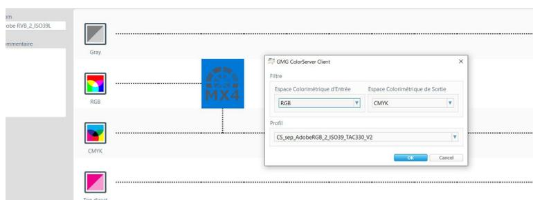
Pour un profil de conversion Isocoated v2 39L vers PSOCOated51. On utilise alors l'outil mx4 en le configurant comme ci-dessous :
