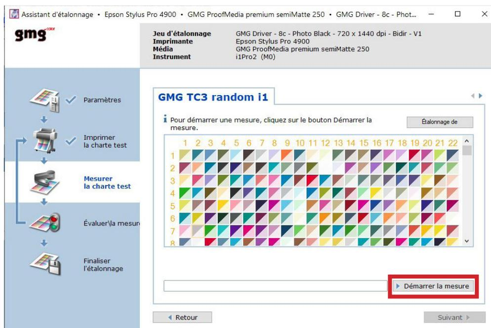
La mesure s'effectue de gauche à droite ou de droite à gauche. Positionnez l'appareil sur sa réglette, appuyez sur le bouton de l'I1, attendez le bip, scannez la bande, puis relâchez le bouton. Deux bips signifient que la mesure de la ligne n'a pas été effectuée correctement, la ligne clignote alors en rouge et le logiciel vous demande de recommencer la lecture de la ligne. A tout moment vous pouvez relire une ligne en cliquant avec la souris sur la ligne à remesurer.
