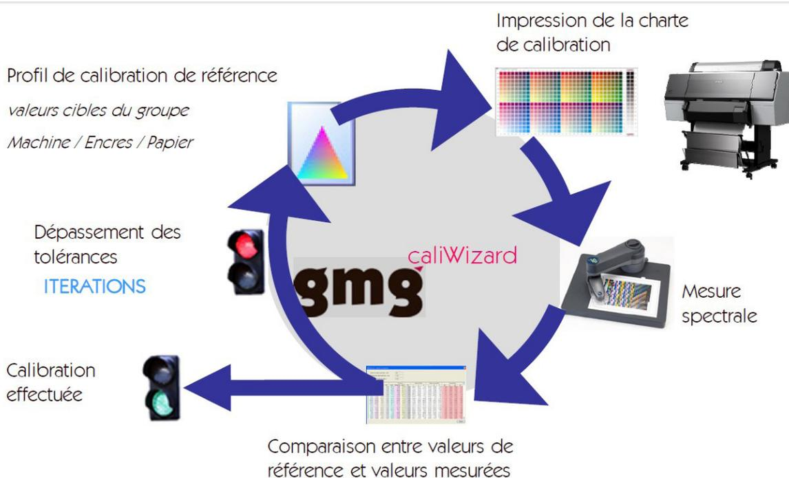
Pour cela, il vous suffit de lancer l'assistant de calibration qui vous guidera pas à pas dans l'étalonnage de votre imprimante. GMG ColorProof fonctionne selon un processus itératif, suivant le schéma ci-dessus: impression, mesures, évaluation...
